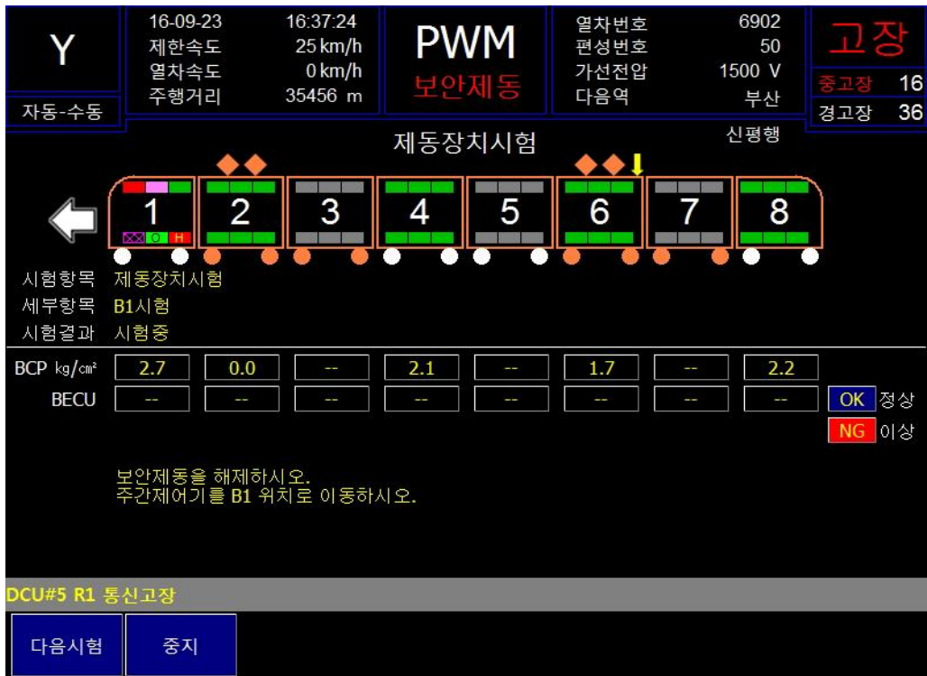
그림5. 차상시험 예시 - 제동시험
